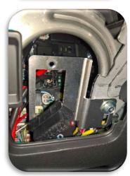
Halterahmen montieren und mit zuvor entfernter Schraube befestigen
