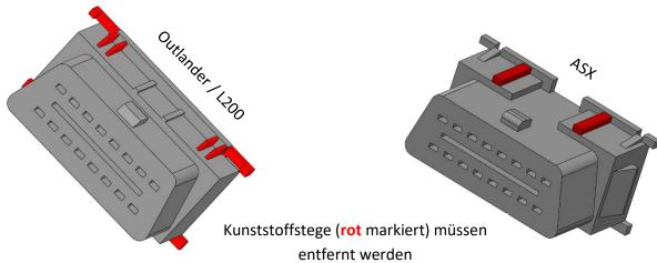
z.B. mit einem Cutter Messer oder einer Kneifzange
