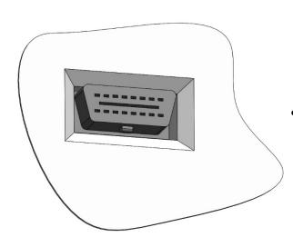
• original OBD Buchse aus Verkleidung lösen.
