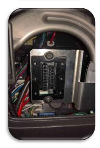
OBD-Buchse mit OBD-Saver Unterteil zusammenführen und in Halterahmen schrauben.
