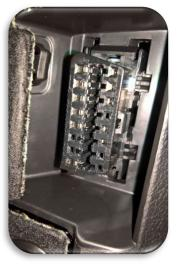
OBD-Buchse aus Halterung lösen und Kunststoffstege entsprechend oberen Bild entfernen
