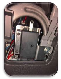
Schlossteil aufsetzen und verschrauben
